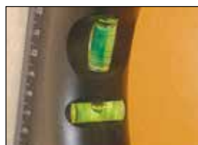
Alignement du trait laser Bubble vials to adjust laser line
